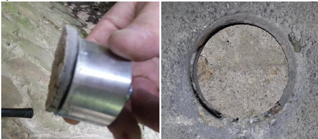
Obrázek 5: Fotodokumentace odrthové zkoušky, vlevo odtržená panenka s vrstvou povrchové úpravy, vpravo plocha po odtržení panenky
